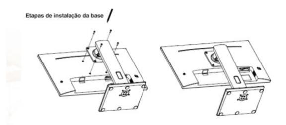
Fixe a base com quatro parafusos M4\*12.
